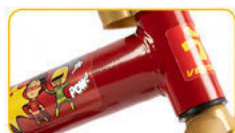
Quadro e garfo em aço carbono
